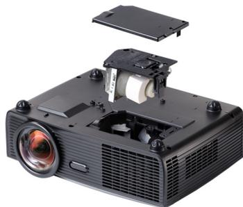
**8** Reinstale a tampa da lâmpada e aperte os dois parafusos.
